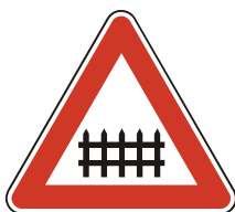
A 25 Železničné priecestie so závorami
